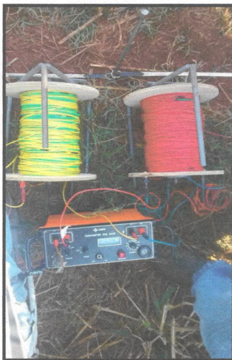
Figura 6: Equipamento Terrameter System SAS4000 da empresa sueca ABEM e as bobinas com os fios utilizados.
